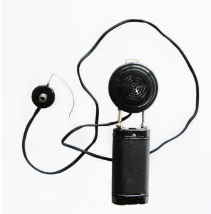
Eines der ersten elektronischen Hörgeräte mit Kohlemikrofon Foto aus: Rainer Hüls, Die Hand am Ohr
